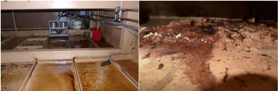
Abbildung 16: Feuchtigkeit im Rumpf-Innenraum, enorme Rostblüten im Bodenbereich unterhalb der Konservierung
